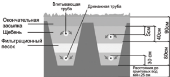
Рис. 6 Поперечное сечение фильтрационной площадки
